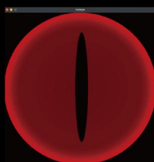
また、撮影時やイベント時に瞳孔が向く方向を任意に制御させるべく、他の小道具装備でも用いられているESP-NOWでのコマンド受信にも対応させました。ラズパイはPCなので、M5Stack NanoC6といった「より小さなマイコン」をUSB子機として接続することができます。瞳孔は、通常時はランダムな方向を見たり瞬きをさせつつも、NanoC6が受け取った信号をPythonがUSBシリアルデバイスとして読むことで、コマンドの受信を検知すると、それに応じて上下左右正面の5方向を向かせる・ランダム視線移動の一時停止と再生の切り替え、といった操作に応えることができるようになりました。
