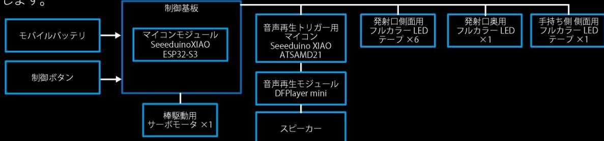
お空が操作用のボタンを押すだけで「棒の展開」→「フルカラーLEDの発光による発射演出」→「棒の収納」という一連のギミックを発動できるようになっています。無線制御システムも導入されており、離れた場所から無線で棒やフルカラーLEDの動作を操作したり、バッテリーの消費を抑える低消費電力モードを選択することも可能にしています。
